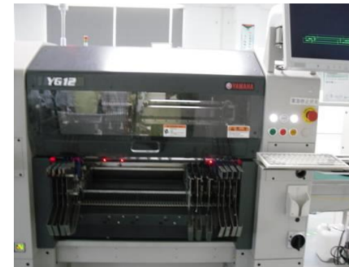
JUKESMT Máquina inserción Chip. Velocidad : 0.2 s/chip Made in Japan
