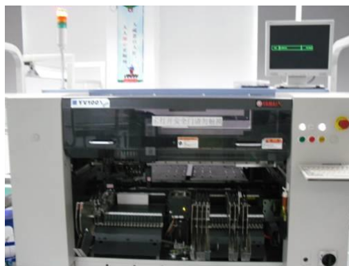
JUKE SMT Máquina inserción Chip . Velocidad: 0.3s/chip Made in Japan
